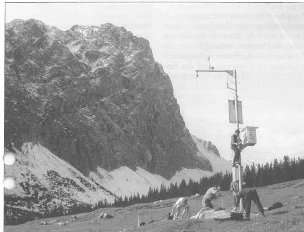
Das ist die Schneemess-Station am Puit-Egg. Die ermittelten Daten werden automatisch über Funk in das Gemeindeamt übertragen
